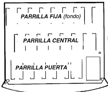
El modelo P14 está equipado con dos parrillas: la fija al fondo del mueble y la de la puerta; el P6 y P8 únicamente monta la parrilla de la puerta.
