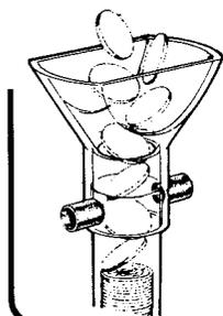
La carga del devolvedor de apoyo se debe realizar a mano, ya que no es autoalimentado, ayudándose del embudo de carga.
