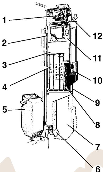
Presionando el gatillo 11 en el sentido de la flecha, el soporte de la columna se libera de su posición de trabajo y bascula hacia el exterior de la máquina.
