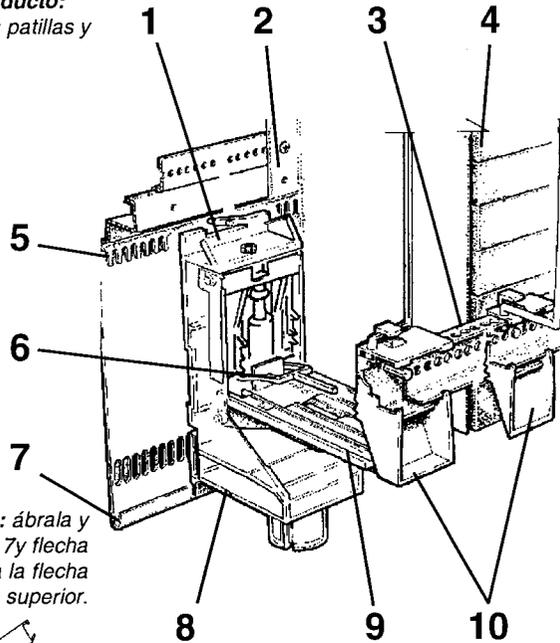
**Para sacar una varilla de cierre:** ábrala y ténsela hacia afuera (vea 4, fig 7 y flecha blanca); tire hacia abajo como indica la flecha negra y saldrá del soporte superior.
