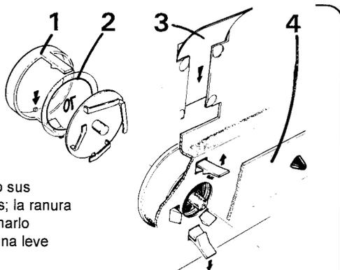
Extraiga el pulsador de selección presionando sus patillas en el sentido que indican las flechas; la ranura en el indicador de precio sirve para posicionarlo dentro del pulsador (vea flecha) y bastará una leve presión para colocarlo de nuevo en su sitio.
