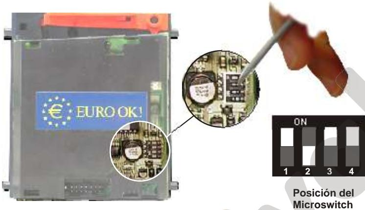
Para configurar el Tempus a los distintos modos es preciso manipular los switches con un objeto punzante, situando a ON u OFF cada microinterruptor según el cuadro anexo.
