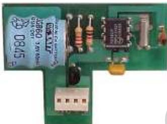
El cambio de tarifa también puede efectuarse utilizando una entrada exterior a través del conector JP5 de la **Tarjeta F.A.**
